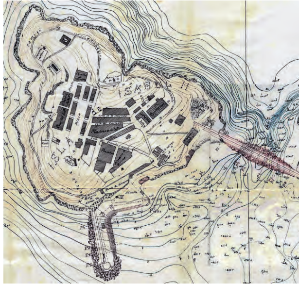
Detalle de la isla de Isabel II donde se proyectan los dos puertos, el dique de unión con la isla del Rey y dique del Oeste. Proyecto definitivo de mejora del puerto de Chafarinas de Manuel Becerra, 1905. Archivo Autoridad Portuaria.
