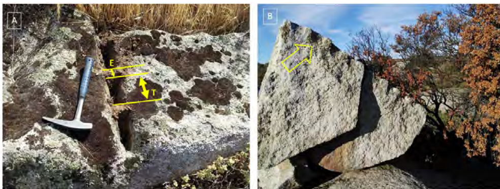
FIGURA 12. IMPRONTAS HISTÓRICAS DEL EMPLEO DE CUÑAS PARA EL CORTE Y ARRANQUE DEL MATERIAL. A: SECTOR N, TAMAÑO O LONGITUD DE LAS CUÑAS (T), ESPACIADO ENTRE ELLAS (E) Y NÚMERO DE CUÑAS EN UNA LABOR, EN ESTE CASO TRES, B: SECTOR S, EMPLEO DE CUÑAS DE GRAN TAMAÑO (20 CM) PARA EL CORTE DE UN BOLO GRANÍTICO. Fotos: los autores
