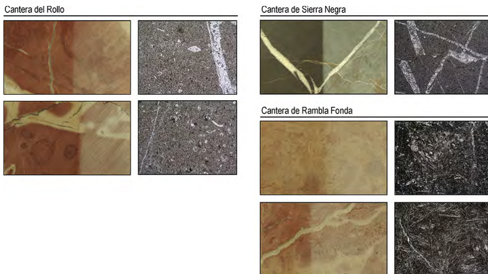
FIGURA 4. IMÁGENES A MESOESCALA Y MICROESCALA DE LAS VARIETADES HISTÓRICAS DE CALIZAS MASIVAS EXPLOTADAS EN LAS CANTERAS DEL MEDIO VINALOPÓ. LAS MUESTRAS DE MANO POSEEN DOS TIPOS DE ACABADO: PULIDO (IZQUIERDA) Y AL CORTE (DERECHA). Autor de las imágenes: Javier Martínez Martínez
