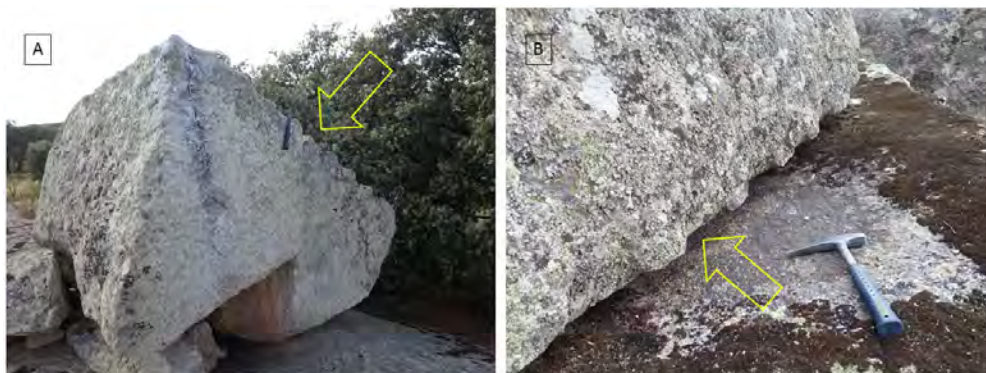
FIGURA 7. ÁREA NE, SECTOR S. A: EXPLOTACIÓN DE BLOQUE GRANÍTICO «IN SITU» CON LAS SUPERFICIES DE CORTE Y LAS MARCAS Y DIMENSIONES DE CUÑAS EMPLEADAS, B: BLOQUE VOLCADO PROCEDENTE DE LA EXPLOTACIÓN DE UNO DE LOS BOLOS, CON LAS IMPRONTAS DE LAS CUÑAS EMPLEADAS EN EL LADO INFERIOR. Fotos: los autores
