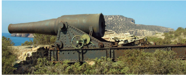
FIG. 23 Cañón de costa Elorza de 24 cm, modelo 1867, número 2, fabricado en Trubia y situado en la batería de los Tristes, Islas Chafarinas. Fotografía de 2007.
