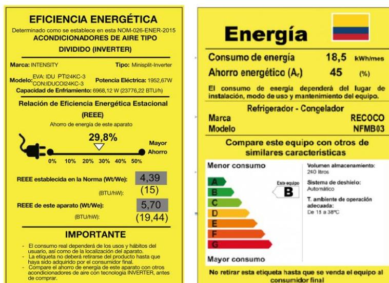
Figura 3. Izquierda- etiqueta energética de un acondicionador de aire *Inverter* según el reglamento mexicano. Derecha – etiqueta energética de un refrigerador según el reglamento técnico colombiano.
