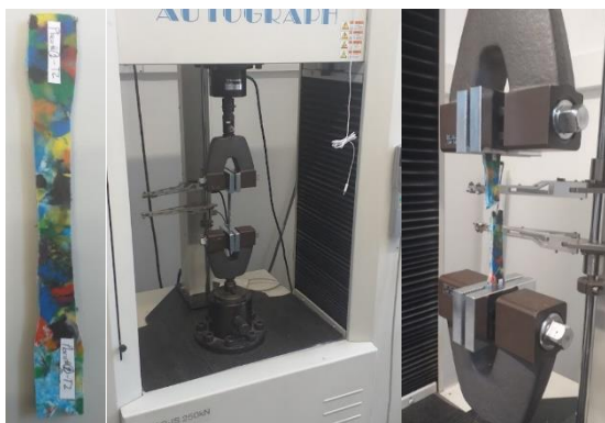
Figura 4. Probeta de ensayo, instalación de prueba mecánica a tensión y falla del material (de izquierda a derecha). Fuente: elaboración propia.
