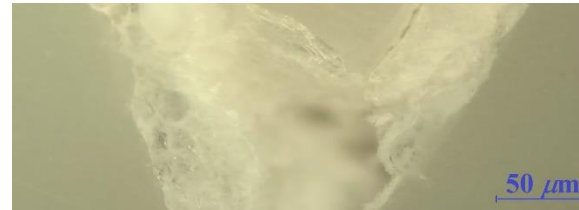
Figura 18. Defeitos na soldadura HGW numa amostra de PP de 10 mm de espessura. a) anomalias de falta de ligação. b) pormenor (b). c) pormenor (c).
