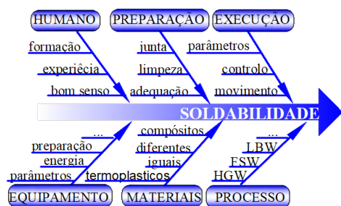
Figura 2 - Diagrama de Ishikawa genérico dos processos de soldadura de termoplásticos. Fonte: Elaboração própria.
