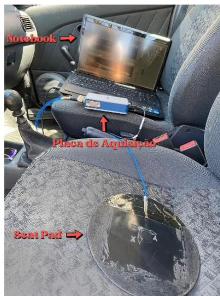
**Figura 06.** Instrumentação montada no interior do veículo.
