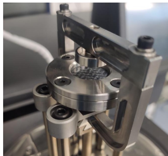
Figura 4. Imagen del utillaje montado en el equipo TA Instruments Q800 DMA con la muestra de material compuesto en el instante previo al ensayo
