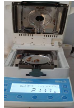
Figura 3. Obtención de la humedad de ladrillo hueco y teja mediante el método directo. Fuente: Elaboración propia.
