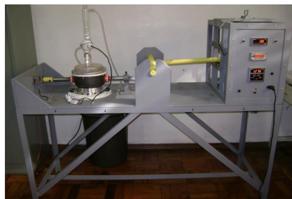
Figura 2. Dispositivo carga constante utilizado para os ensaios de corrosão sob tensão.
