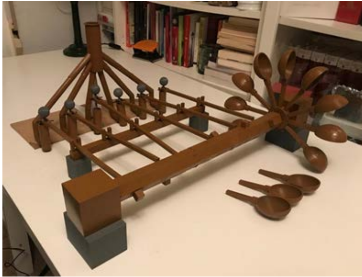
Figura 14. Ensamblaje de la bomba de seis cilindros de Taqī ad-Dīn. Elaboración propia.
