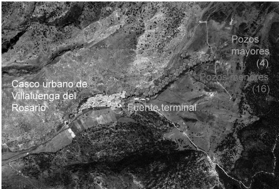
Figura 3. IMAGEN AÉREA CON INDICACIÓN DE LA SITUACIÓN DE LOS POZOS DEL QANAT Y LA FUENTE TERMINAL (ELABORACIÓN: MANUEL RAMÍREZ Y ALEJANDRO PÉREZ).
