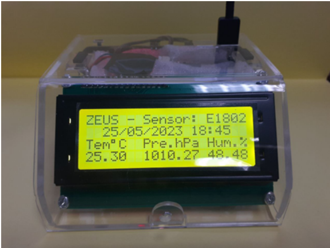
Figura 7.7: Aspecto final del Sensor Zeus ensamblado en su caja de Metacrilato
