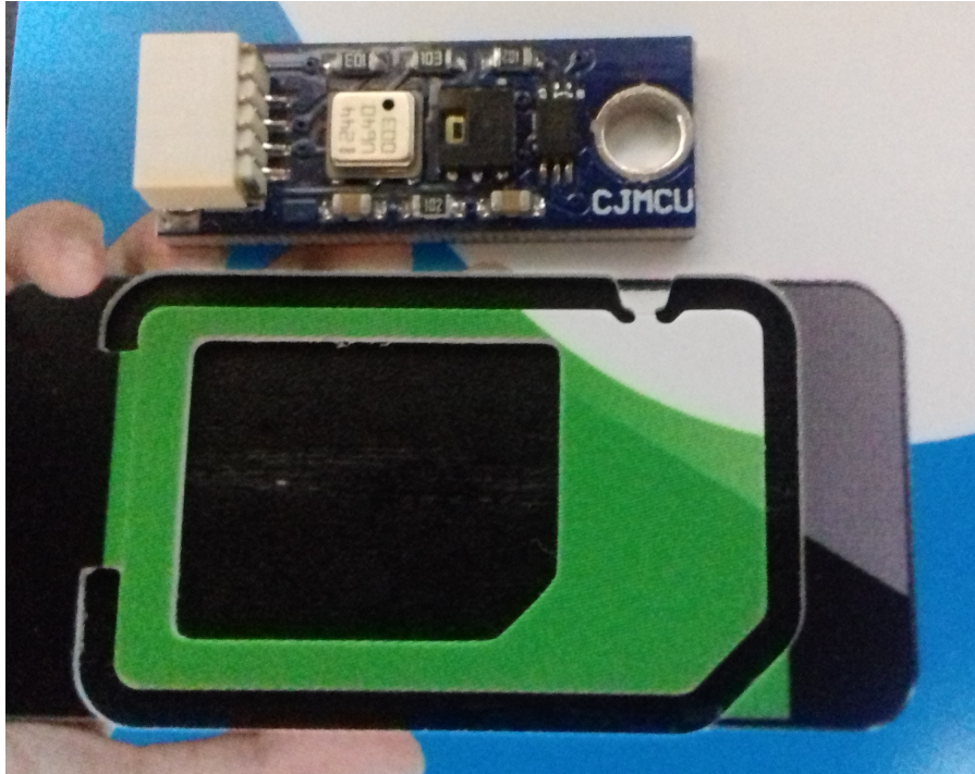
Figura 4.4: Sensor trifuncional comparado con una tarjeta SIM
