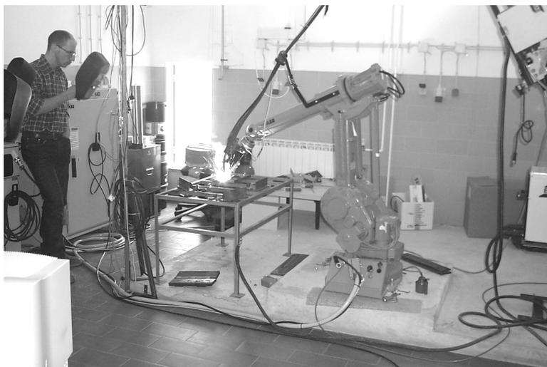
Fig. 1. Sistema de soldadura robotizada para aplicações industriais.
