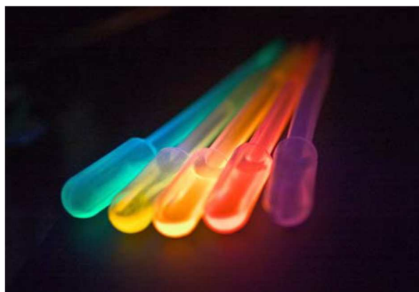
Figura 2. Emisión de luz de diferentes puntos cuánticos (quantum dots) en función del tamaño de NP 6 .
