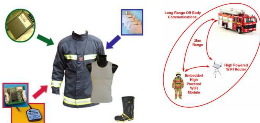
Figura 44. Prendas inteligentes con diversos sensores y esquema de comunicaciones del Proyecto Proetex 78 .
