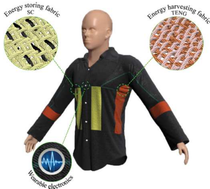
Figura 39. Esquema del funcionamiento de una prenda inteligente. Integra un nanogenerador triboeléctrico (TENG), un supercapacitor (SC) y dispositivos electrónicos “ vestibles ” (WE) 67 .
