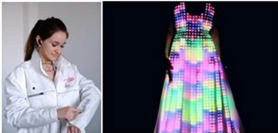
Figura 46. Chaqueta con MP3 y botones de control integrados en la prenda, y vestido inteligente con efectos luminosos 83 .
