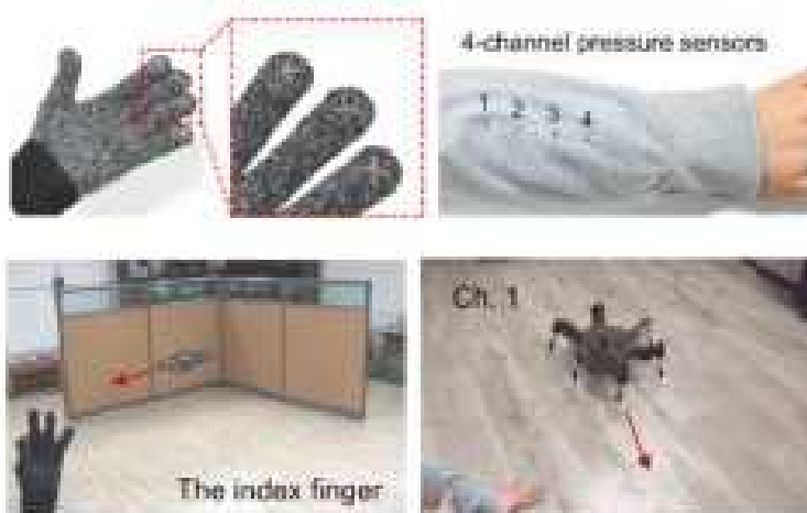
Figura 42. Utilización de sensores de presión en prendas textiles para dirigir el movimiento de un dron y un pequeño robot 95 .
