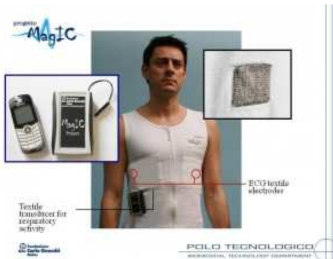
Figura 45. Camiseta inteligente MagIC con sensor de ritmo respiratorio y electrocardiograma (ECG) incorporados a la prenda 96 .
