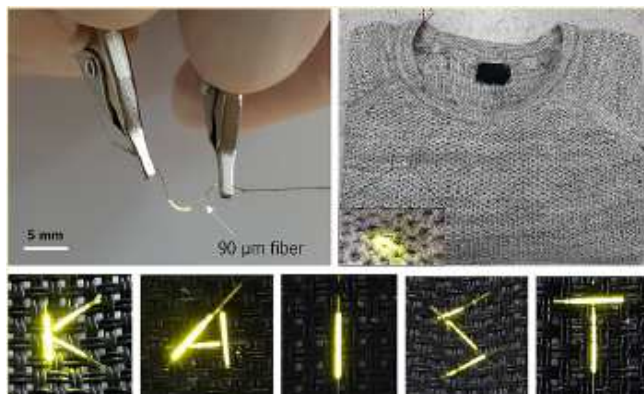
Figura 40. Diodo orgánico emisor de luz (OLED) en cuya síntesis se han empleado nanopartículas de ZnO 71 .
