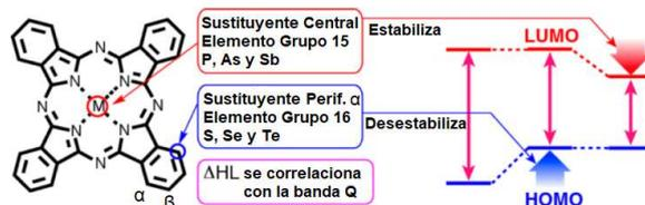
Figura 14. Diseño molecular de Ftalocianinas absorbiendo en el IR cercano.
