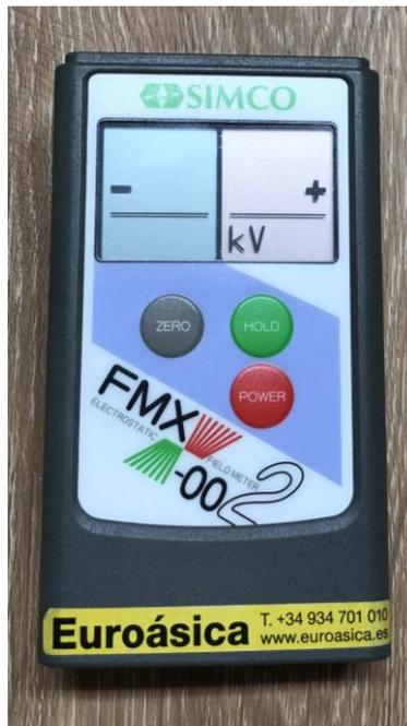
Figura 6: Medidor de campo electrostático
