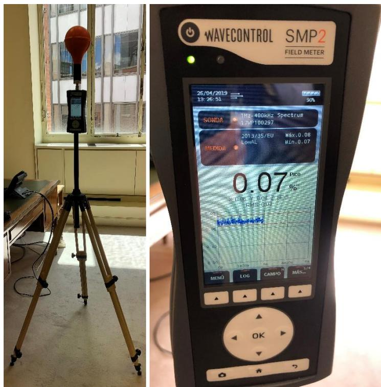
Figura 7: Medidor de campo electromagnético. (Izq: montaje completo. Dch.: unidad central)
