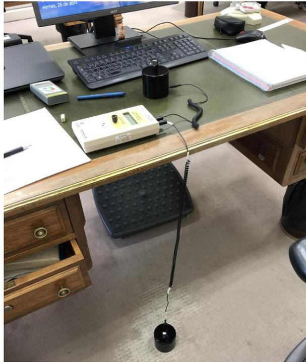
Figura 5: Ohmímetro. Medida de resistencia punto a punto
