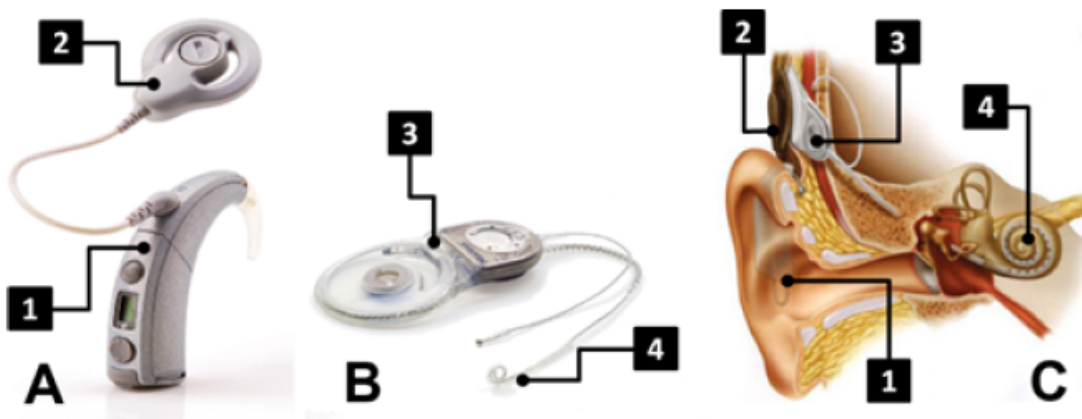
Figura 1.2: Estructura del implante coclear (C). La parte externa (A), compuesta del micrófono y el procesador de voz (1) así como de la bobina (2). La parte interna (B) formada por el receptor-estimulador (3) y el array de electrodos (4).
