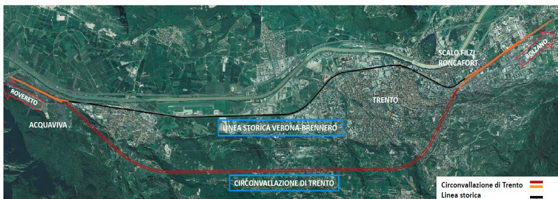
Imagen 1: En color negro el trazado de la línea ferroviaria histórica mientras que el trazado de la circunvalación ferroviaria es representado en naranja (a cielo abierto) y en rojo (en galería). Fuente: Rete Ferroviaria Italiana
