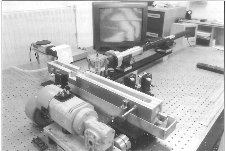
*Dispositivo interferométrico para medir la distribución de temperaturas en una llama propagándose sobre un combustible líquido.*
