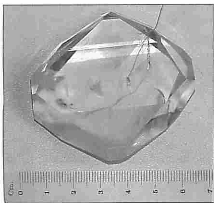
Monocristal mixto de TGS_x-TGSe_{(1-x)} crecido en el laboratorio de Electricidad y Magnetismo.
