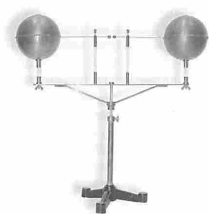
Figura 10. Experimento del oscilador de Hertz.
