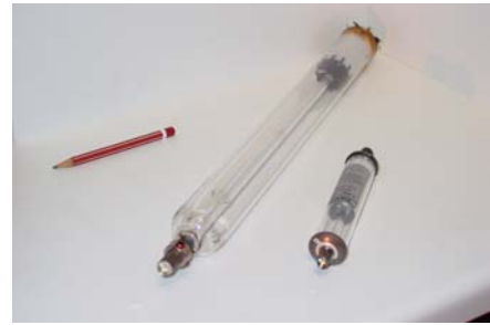
Figura 9. Cavidades de dos láseres de He-Ne.
