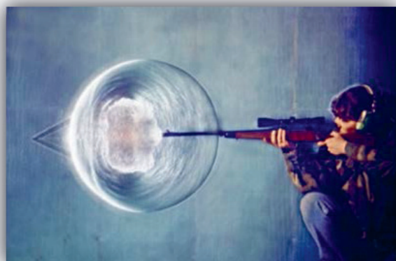
Figura 1. Ondas de choque producidas por un avión supersónico (izquierda) y por el disparo de un proyectil (derecha).
