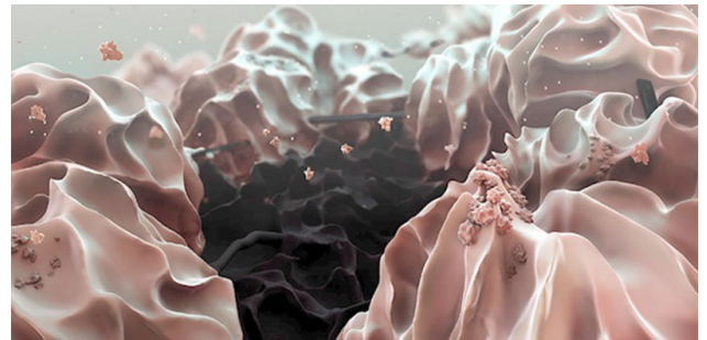
Figura 8. Vista microscópica con colores retocados del electrodo de carbono de una batería de Li-aire. En el centro se ve el electrodo de carbono, hecho con óxido de grafeno reducido altamente poroso (de color negro), al que rodean partículas de hidróxido de litio de unas 20 micras (de color rosa), que se forman en la descarga de la batería pero se pueden eliminar con relativa facilidad por el disolvente utilizado en el electrolito. Según Liu y col.
