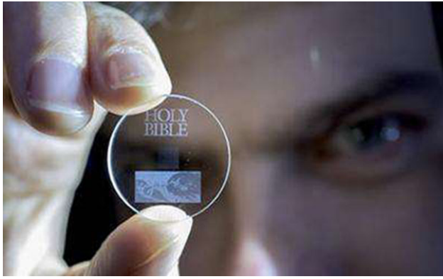
Figura 6. Vidrio de cuarzo cuya nanoestructura presenta unas propiedades sobresalientes de capacidad de almacenamiento de información y durabilidad. Según Phys. Org. , 15 de febrero de 2016.
