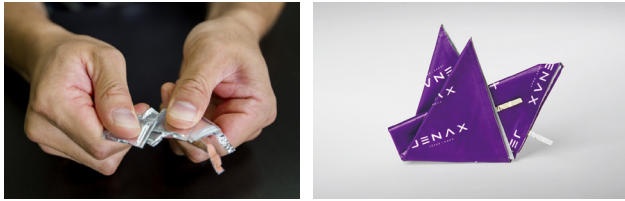
Figura 9. Nuevas formas de baterías para dispositivos flexibles. Izquierda: Batería desplegable con excelentes propiedades electroquímicas y mecánicas, según Song y col. Derecha: Batería plegada en forma de barquito, de la firma surcoreana Jenax, según Quigley.
