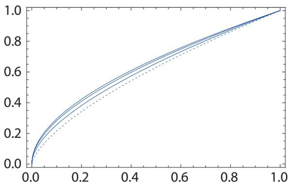
Figura 3. Velocidad de los iones adimensional en función de la coordenada espacial adimensional. De abajo hacia arriba, curvas de la velocidad adimensional para los valores del campo extractor adimensional que aparecen en la tabla anterior tomados en orden creciente. La curva punteada representa el caso de corriente máxima.
