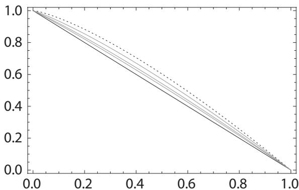
Figura 2. Potencial eléctrico adimensional en función de la coordenada espacial adimensional. De arriba hacia abajo, curvas del potencial eléctrico adimensional para los valores del campo extractor adimensional que aparecen en la tabla anterior tomados en orden creciente. La curva punteada representa el caso de corriente máxima. Se representa también el caso trivial en el que no existe carga espacial.
