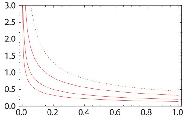
Figura 4. Densidad de carga adimensional en función de la coordenada espacial adimensional. De arriba hacia abajo, curvas de la densidad de carga adimensional para los valores del campo extractor adimensional que aparecen en la tabla anterior tomados en orden creciente. La curva punteada representa el caso de corriente máxima.
