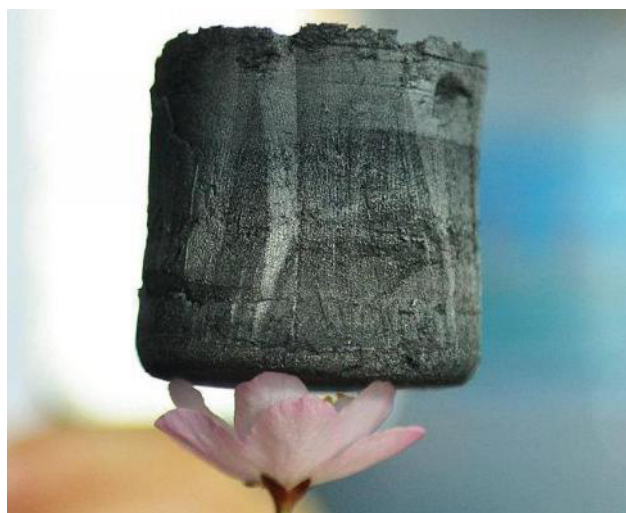
Figura 4. Aerogel de grafeno posado sobre una flor de cerezo. Fuente: https://scifocusperiodismo.wordpress.com/2013/04/15/aerogel-de-grafeno-el-material-del-futuro-mas-ligero-del-mundo .
