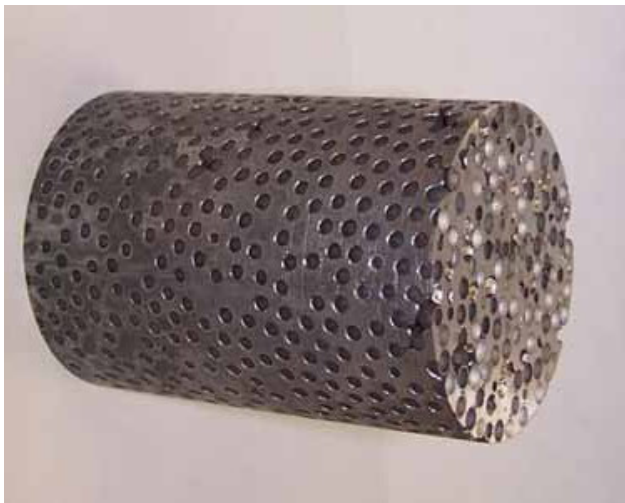
Figura 10. Espuma metálica compuesta (CMF) fabricada con esferas de acero y matriz de aluminio utilizando una técnica de fundición. Fuente: http://www.labspace.net/102021/New_material_mimics_bone_to_create_better_biomedical_implants .
