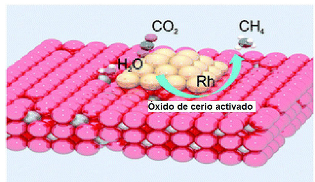
Figura 5. Esquema del proceso de producción directa de hidrocarburos (tales como el \text{CH}_4 aquí representado) a partir de \text{CO}_2 y \text{H}_2\text{O} , en óxido de cerio activado con Rh como catalizador, mediante ciclos termoquímicos alimentados por energía solar. Según Alxneit y col.
