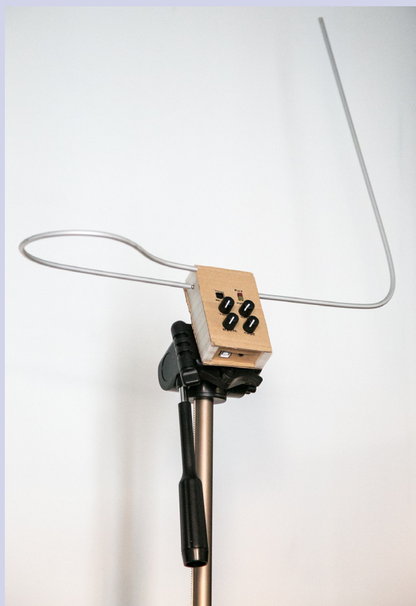
Figura 2. Aspecto final del theremin desarrollado por los autores. Fuente: Almudena Martín Castro.
