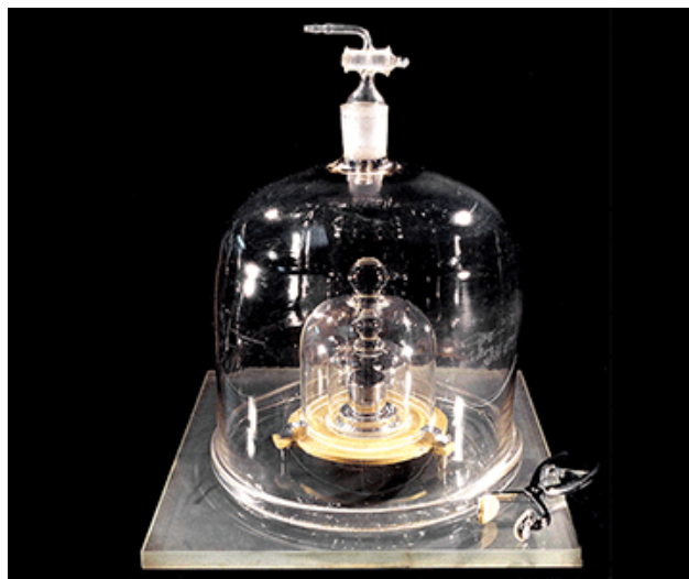
Figura 1. El prototipo de platino e iridio que ha sido el estándar del kilogramo desde 1889.
