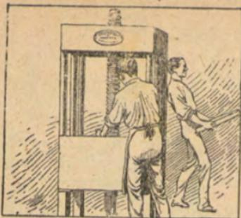
∩ La *pasta* usada por los semoleros es muy espesa y se halla teñida con un poco de *azafrán*. Colocada entre una *prensa* y un *molde agujereado*, se convierte en *fideos*, *macarrones*, etc., etc.
