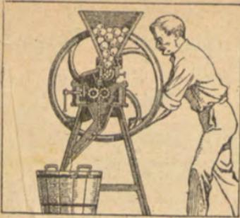
☞ Para obtener *sidra*, bebida del norte de España, se trituran primero a *máquina* las *manzanas* o *peras* escrupulosamente escogidas para dicho objeto.
