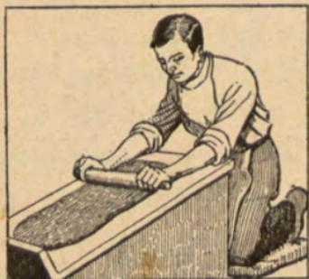
Al cacao desmenuzado se le mezcla azúcar, de *caña* a ser posible, y valiéndose de un *rodillo* se le aplasta sobre una piedra que contiene fuego debajo, con la cual se va formando una *pasta*.
