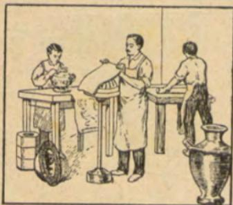
☞ La pasta de *porcelana* se obtiene amasando una tierra llamada *caolín*; los utensilios de porcelana, se hacen *comprimiendo* la pasta contra un molde y *vidriándolos* después, con la cual se vuelven *transparentes*.
