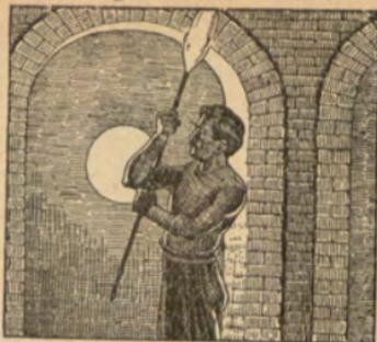
Mételo luego en un *molde* que cierra con una mano, mientras *sopla* con fuerza por el otro extremo de la *caña*, para que el vidrio se *ensanche* hasta tocar el interior del molde.
