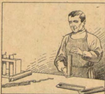
∞ Para fabricar *velas* a mano, se vierte cera en unos moldes en cuyo centro se ha colocado una mecha tren- zada y resistente, de algo- dón.
