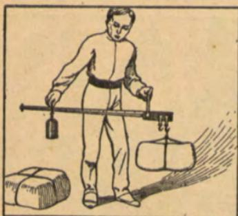
∩ La *romana* es una *barra* de hierro que se suspende de un *punto* fijo, colocando en un extremo el *fardo* que se desea *pesar*, y en el otro la *medida* que señala el *peso* correspondiente marcado en la *barra*.
