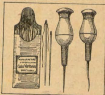
☞ Para fabricar *agujas*, se toman pedacitos de alambre de acero; se les *aplasta* por un extremo abriéndoles un agujero para el hilo, y se *afilan* en una muela por el otro, hasta dejarles una punta *afilada*.
