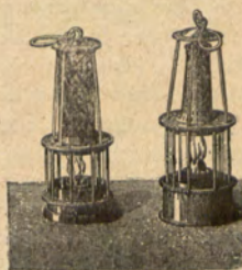
Lámparas Davy perfeccionadas, para evitar explosiones.
