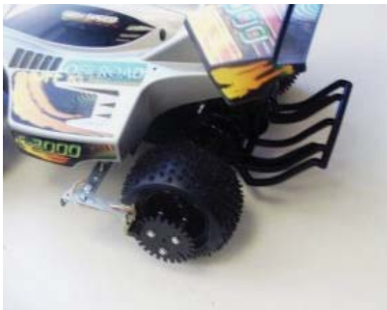
Figura 4. A la izquierda detalle de la situación de la rueda dentada para el codificador óptico. A la derecha detalle del emplazamiento de la Pt100
