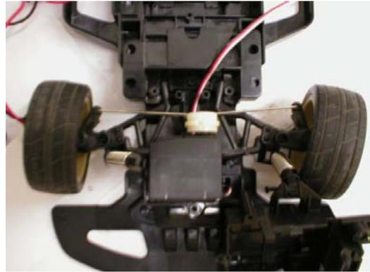
Figura 3: Sustitución del motor de serie por un servomotor
