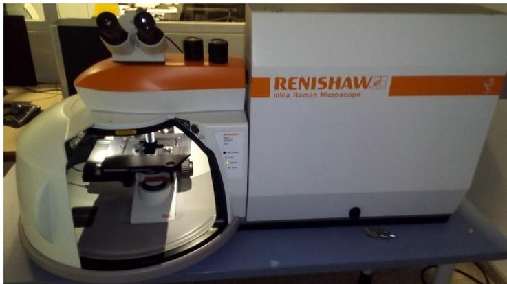
*Figura 110. Equipo empleado, que consta de espectroscopio Raman acoplado a microscopio óptico (hasta x100 de magnificación).*
