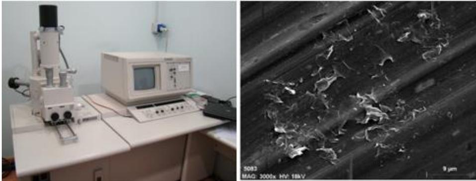
*Figura 98. Fotografía del microscopio empleado y micrografía de SEM de un GRM obtenido mediante procesos OER.*
