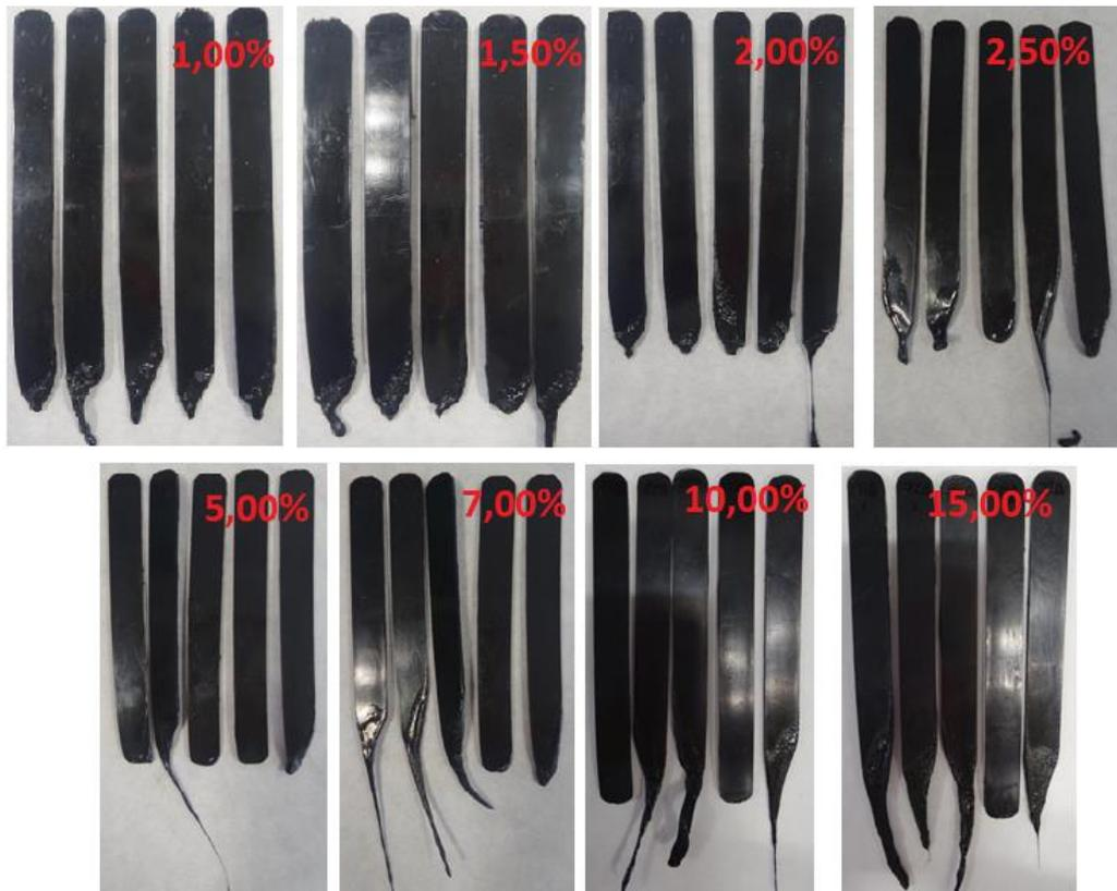
Figura 290. Especímenes de varias formulaciones de PA6-G6 tras el test de resistencia a la llama UL94.
