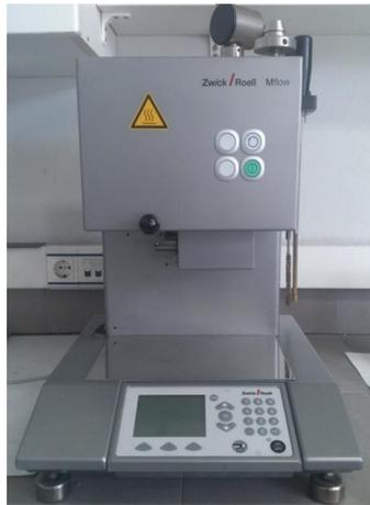
Figura 124. Plastómetro de extrusión empleado.
