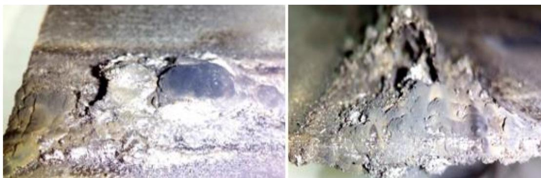
*Figura 78. Imágenes de la capa intumescente tras el ensayo de resistencia a la llama en un composite preparado con fibra de vidrio, resina epoxi y G4.*
