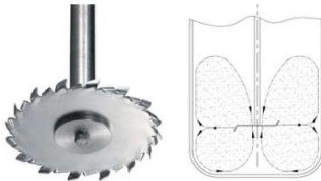
*Figura 134. Disco cowles y representación esquemática del movimiento que provoca en el fluido.<sup>313</sup>*
