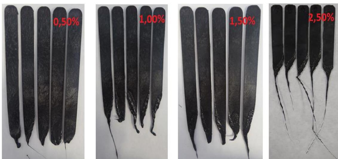
Figura 283. Probetas de los composites de PA6-G3 tras realizar el test de resistencia a la llama UL94.
