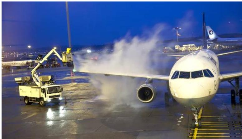
*Figura 360. Tratamientos actuales para descongelar partes del avión, que pueden ser reemplazados por composites con materiales grafénicos que tengan capacidad de descongelarse.*
