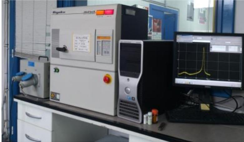
*Figura 97. Equipo empleado para la adquisición de difractogramas de rayos X en polvo.*
