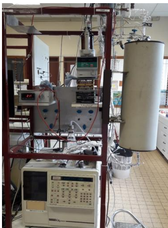
Figura 3. 8 Equipo empleado en la reacción modelo de deshidrogenación del ciclohexano.
