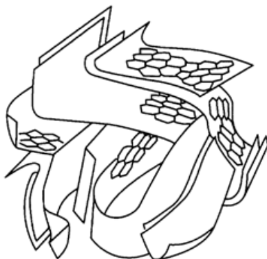
Figura 1. 21 Esquema grafico de la estructura turboestrática del AC. 191
