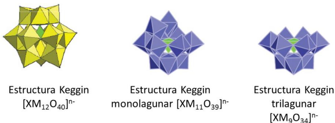
Figura 1. 16 Estructuras isómeras de la estructura Keggin base de los POMs. 168
