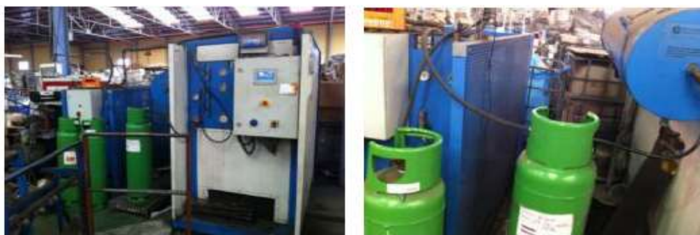
Fotografías 5.2.5.- Detalle de la máquina de extracción de gases y aceites. Detalle del almacenamiento del aceite y de los gases en bombonas separadas e identificadas.
