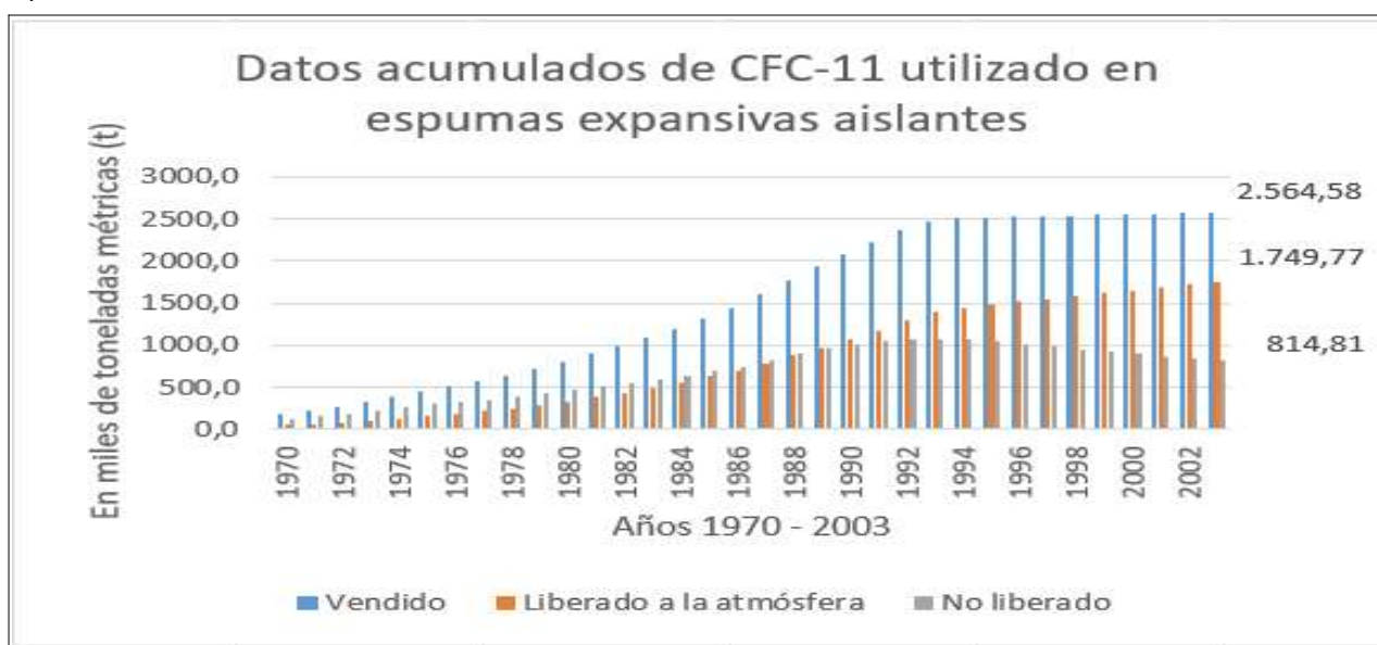
Figura 1. CFC-11 utilizado en espumas expansivas aislantes (1970-2003). Fuente: Elaboración propia en base a datos de AFEAS 46 .
