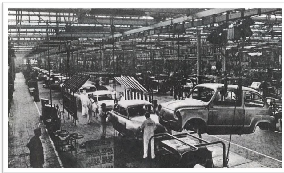
Ilustración 31: “Una muestra del actual desarrollo industrial de España: nave de montaje de carrocerías de la fábrica de automóviles SEAT (Barcelona).” 145
