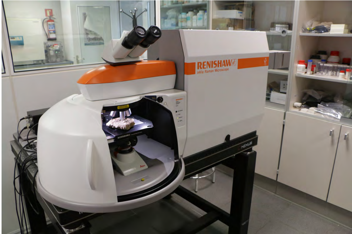
Ilustración 40 Fotografía del equipo de trabajo Raman. Laboratorio IBEA-UPV.
