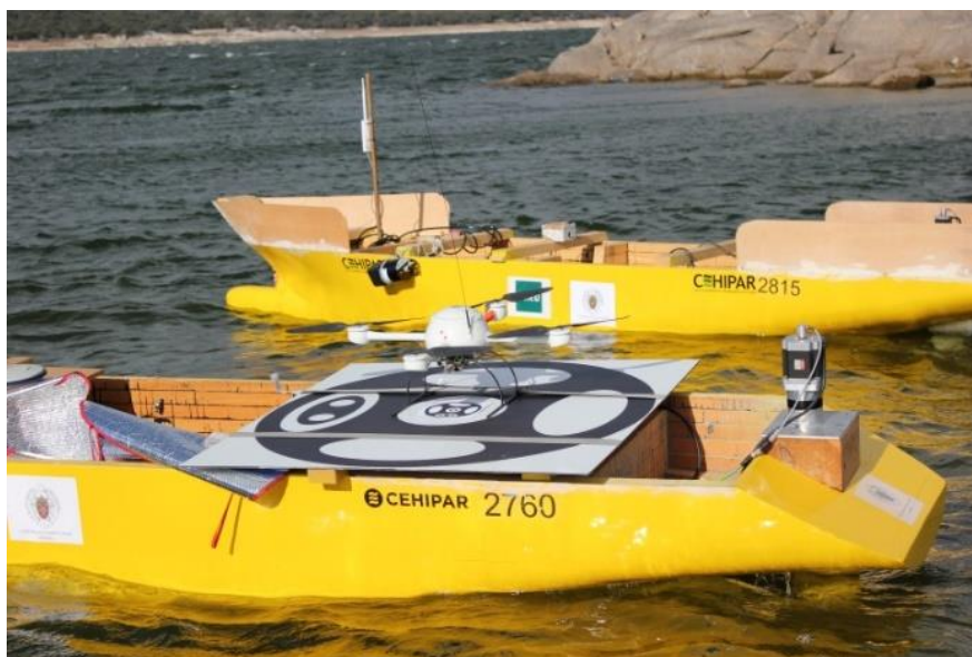
Figura 3-3 – Plataforma de aterrizaje de UAVs a bordo de un barco autónomo
