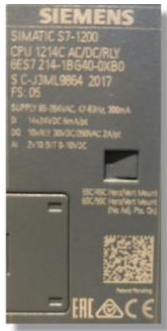
Figura 62: Placa identificativa del PLC S7 1200
