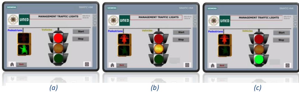
Figura 81: Pantallas del HMI, sistema control de tráfico.
