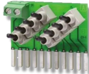
Figura 61: Placa de interruptores (entradas digitales).
