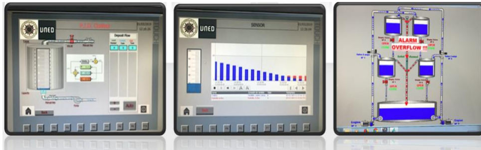
(a) (b) (c) Figura 80: Sistemas de control simulados a través de HMI y TIA Portal.
