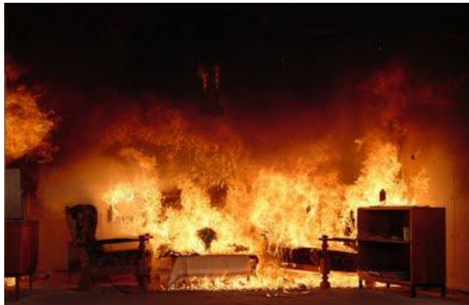
Figura 6: Combustión súbita generalizada (flashover) 46
