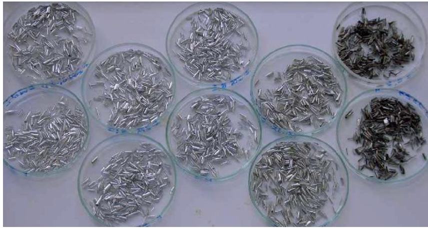
Figura 2.33. Distintas coloraciones de virutas de magnesio, tras 24h de inmersión en distintos lubricantes base acuosa [148].
