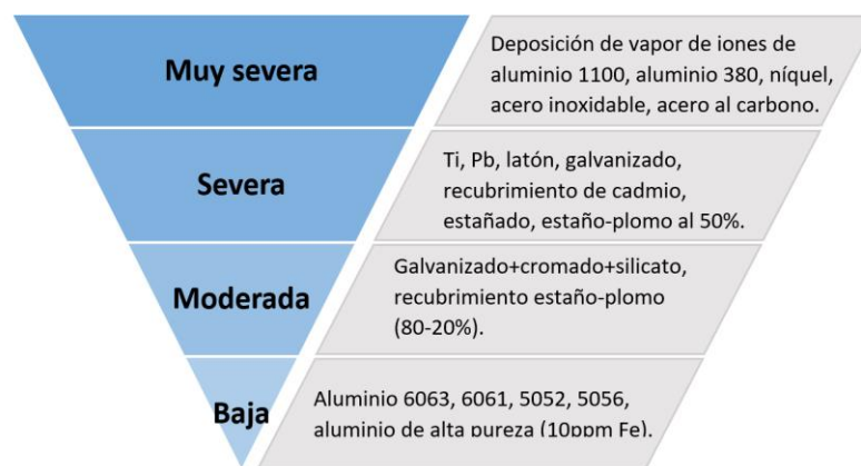
Figura 2.9. Corrosión galvánica relativa de diferentes materiales en sujetadores unidos a la aleación AZ91D, basado en [27].
