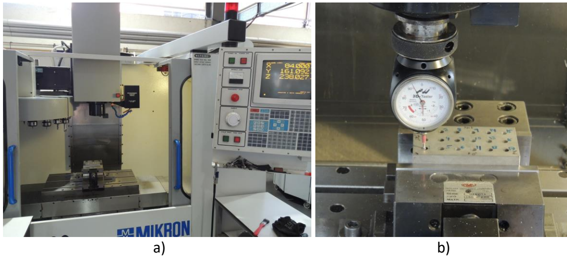
Figura 4.4. a) Centro de mecanizado Micron VCE 500, b) mordaza hidráulica y comparador.
