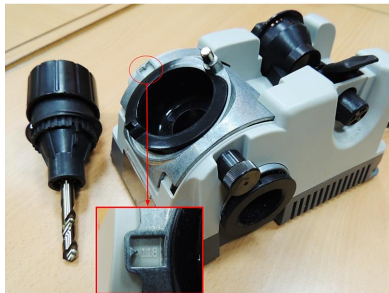
Figura 4.6. Afilador de brocas y detalle del selector del ángulo de punta (Figure 4.6. Drill sharpener and point angle selector detail).
