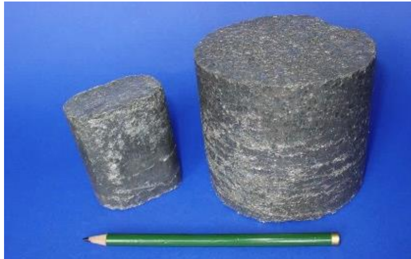
Figura 2.34. Briquetas de Al-Mg compactadas a partir de virutas procedentes del mecanizado [15].
