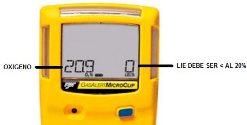
Figura 133. Comprobación con explosímetro
