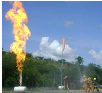
Figura 150. Fuga gas con inflamación
