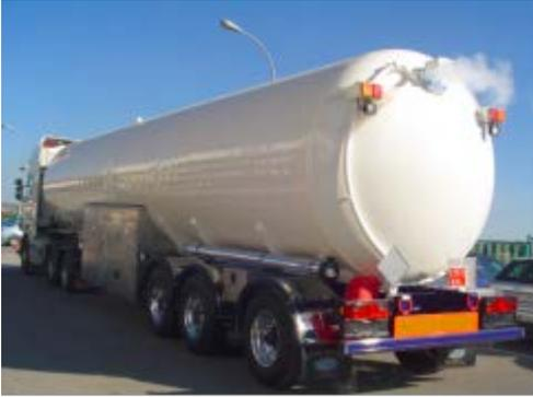
Figura 12. Cisterna aislada al vacío
