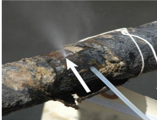
Figura 158. Fuga gas. Peligro quemadura por contacto (fuente: archivo)
