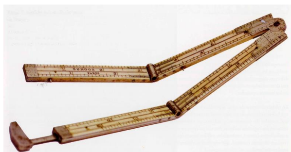
Fig. 30 Regla de medida con las escalas en varas de Burgos. Figura incluida en [Colamar Albajar. M.A. 2019]. Página 301
