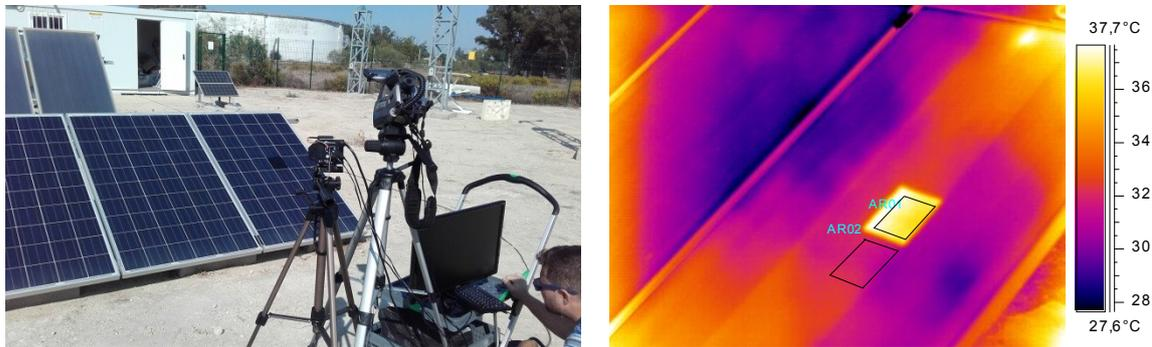
Figura 3.30: Disposición de elementos para analizar célula caliente en módulo FV por efecto de la presencia de nubes.
