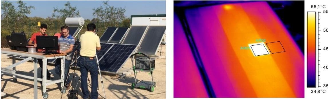
Figura 3.32: Disposición de elementos para validación de método de estimación térmica de módulo FV por método termográfico.
