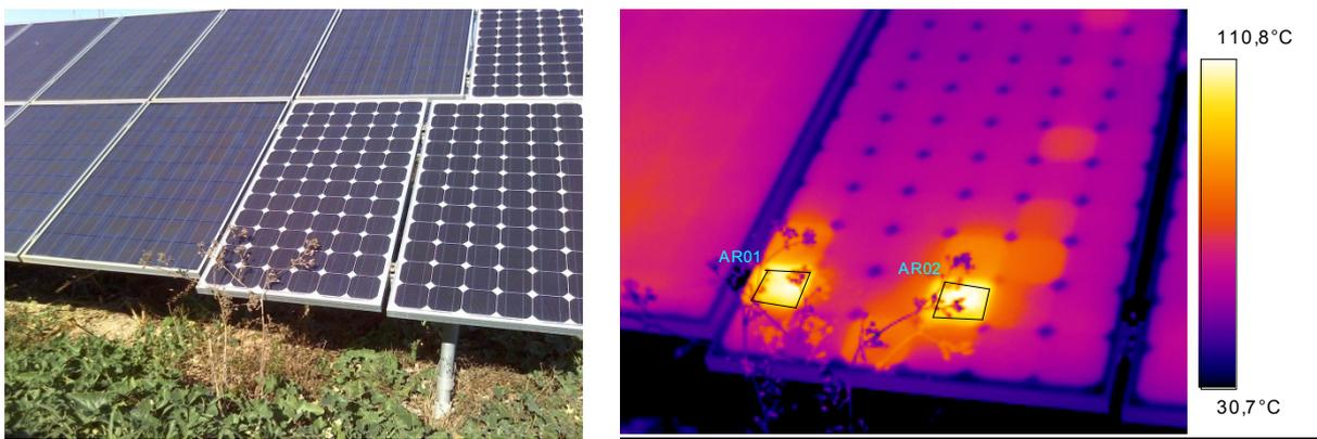
Figura 5.15: Análisis termográfico sobre el terreno N° 4 en módulo AV6 (vista frontal).
