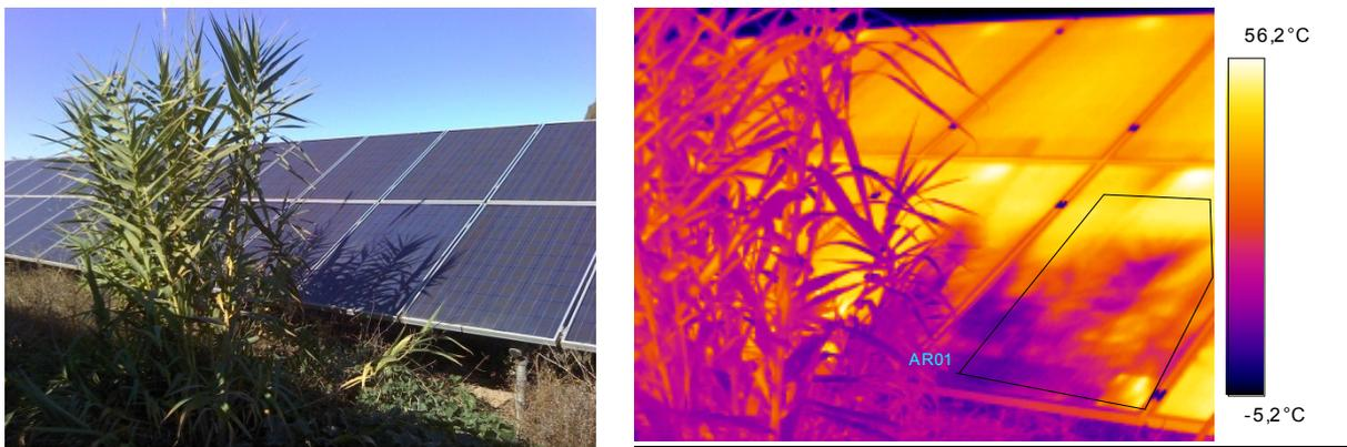
Figura 5.17: Análisis termográfico sobre el terreno N° 4 en módulo AR4.
