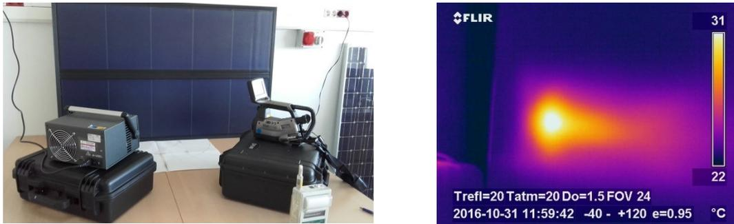
Figura 3.4: Reflexión de tipo difusa que se produce sobre módulo FV de Si-a.
