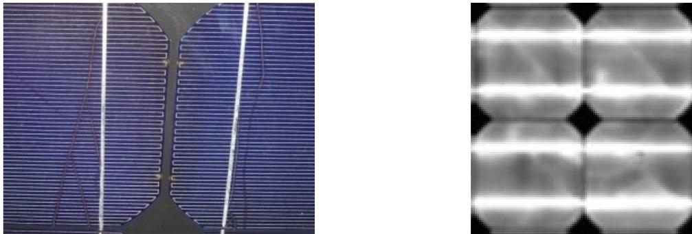
Figura 2.5: Rotura de célula de Si-m apreciable visualmente (izquierda) y visualizadas mediante termografía Lock-in (IEA-PVPS Task 13 2014).
