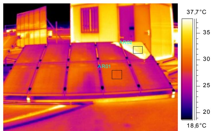
Figura 3.3: Imagen termográfica con efecto de reflexión solar de elemento arquitectónico cercano.
