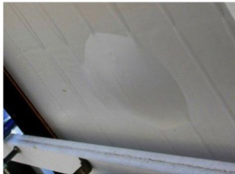
Figura 2.3: Delaminación de la cubierta posterior (IEA-PVPS Task 13 2014).
