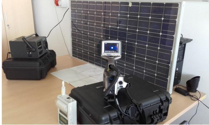
Figura 3.28: Disposición de calibrador IR y cámara termográfica para estudio de reflectividad sobre módulo FV.
