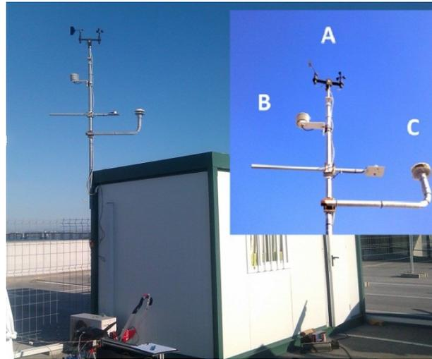
Figura 3.12: Estación Meteorológica (Anemoveleta, Piranómetros y Sonda de Temperatura) de Campbell Scientific.
