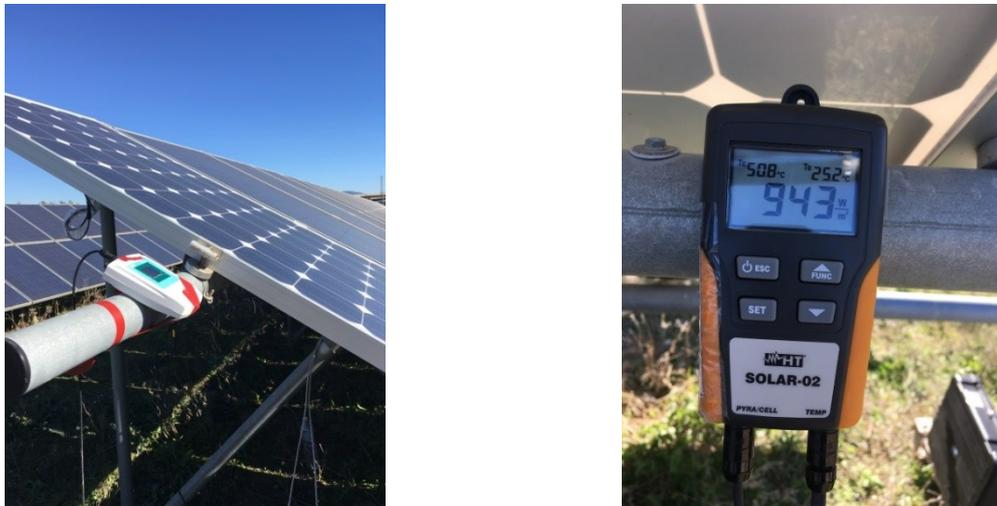
Figura 5.7: Instalación de piranómetro portátil sobre el plano de los módulos FV.
