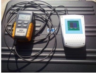
Figura 3.14: Equipo portátil medida de radiación solar Solar-02 de HT Instruments.
