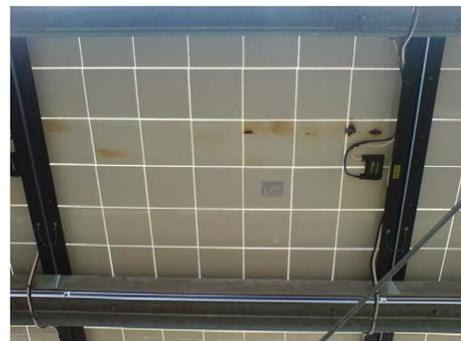
Figura 2.7: Quemaduras apreciables visualmente en célula (izquierda) y en la cubierta posterior (derecha) (IEA-PVPS Task 13 2014).
