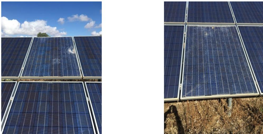
Figura 5.5: Imagen detallada de módulos FV con rotura de cubierta frontal.
