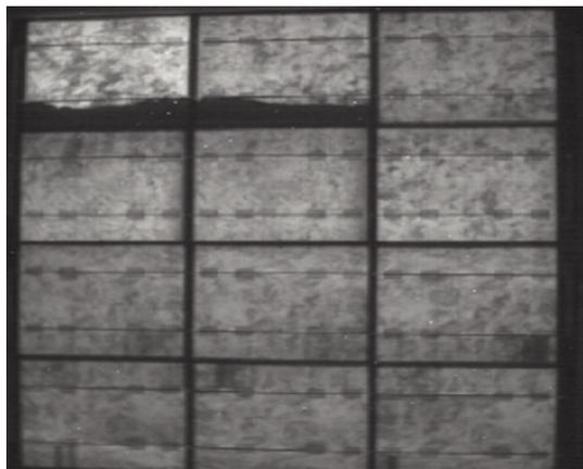
Figura 2.25: Imagen de defectos de una célula solar identificada mediante ensayo electroluminiscente (EL).
