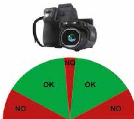
Figura 2.27: Ángulo de inspección recomendado (verde) y no recomendado (rojo) al realizar inspecciones termográficas sobre módulos FV (FLIR Systems 2011).
