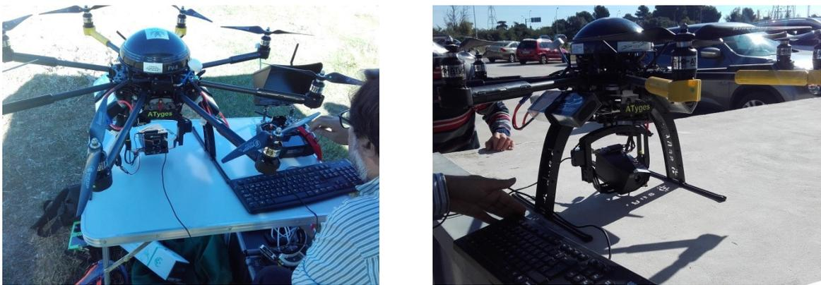
Figura 5.2: Imágenes del dron utilizado para la inspección termográfica aérea.
