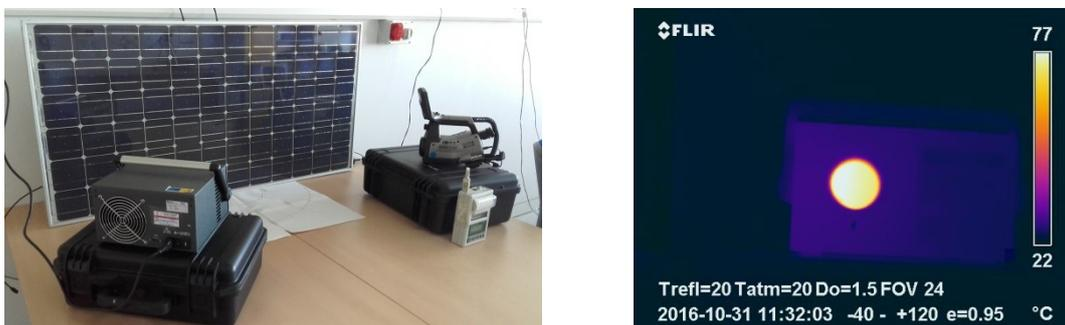
Figura 3.5: Reflexión de tipo especular que se produce sobre módulo FV de tipo Si-m.
