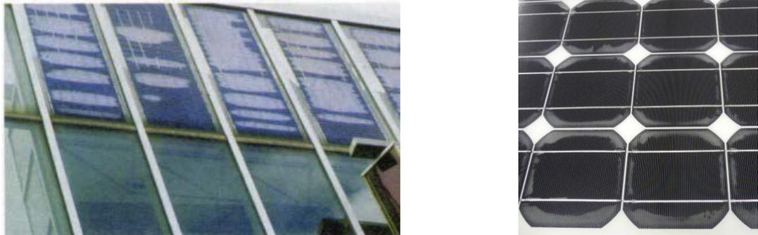
Figura 2.2: Delaminación de módulos de Si-p (izquierda) y de módulo de Si-m (derecha) (IEA-PVPS Task 13 2014).
