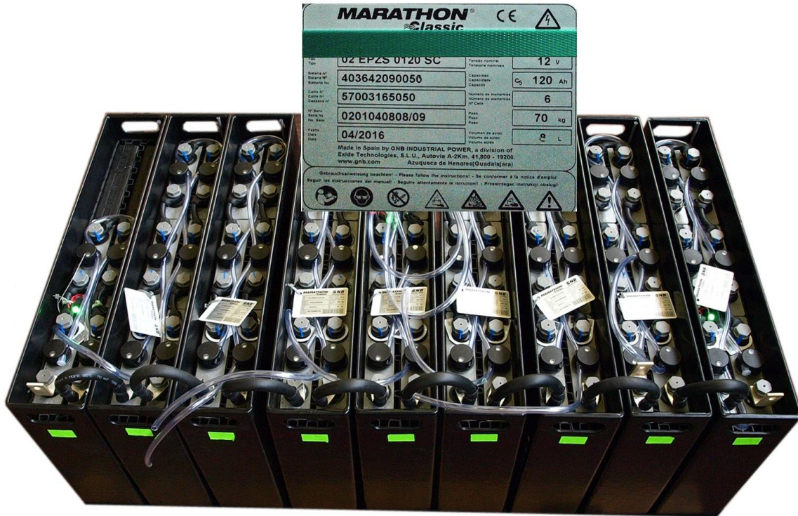
Figura 38: Batería de los coches 2000B.
