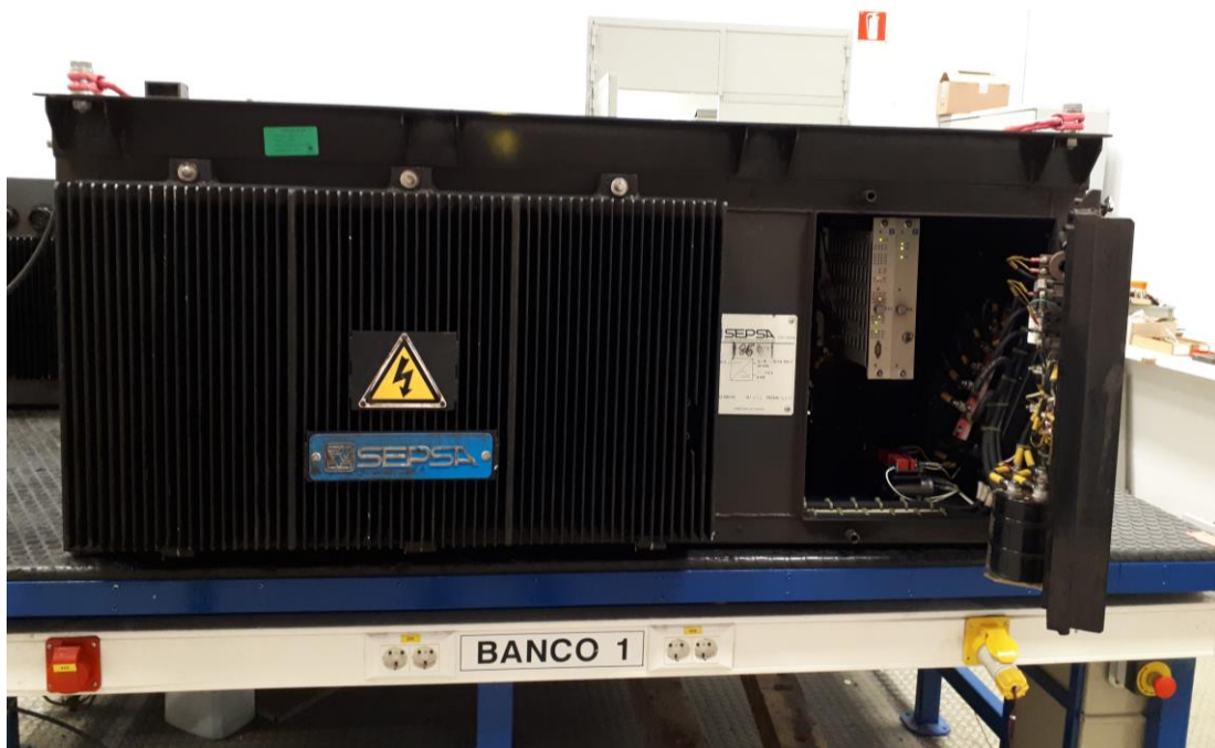
Figura 59: Convertidor de 60kVA de los coches 2000B.
