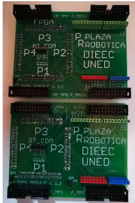
Figura 71. Versiones 1.1 (arriba) y 1.2 (abajo) de la PBA del módulo principal.
