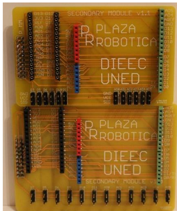
Figura 60. Versiones 1.1 (arriba) y 1.0 (abajo) de la PBA del módulo secundario.
