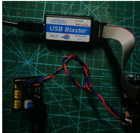
Figura 103. Carga del firmware en la FPGA.
