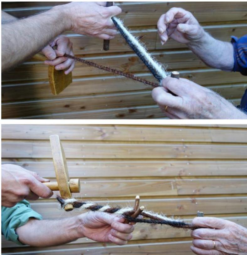
Figura 55- A) Plegado de la cuerda tricolor para observar con mayor facilidad las 3 capas de la cuerda. B) Trenzado de tres hilos utilizando el bastón de volante guía junto con la ayuda de un palo de madera en forma de horquilla. Fotos: Gonthier (2014).
