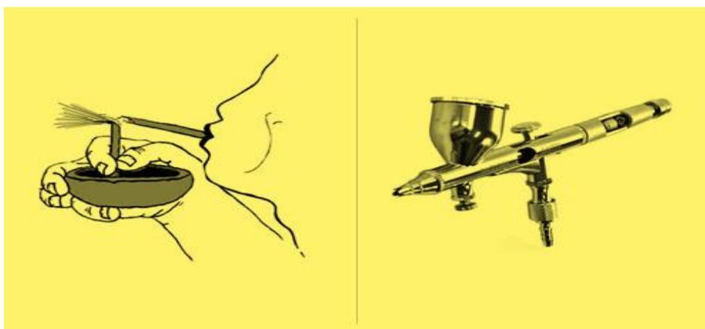
**Figura 4- Reproducción de un aerógrafo, utilizando dos diáfisis óseas y un cuenco como recipiente. Posiblemente este sistema sería similar al que se utilizó durante el Paleolítico Superior. En la imagen de la derecha un aerógrafo actual. Los dos utilizan el mismo principio, el llamado efecto Venturi.**
