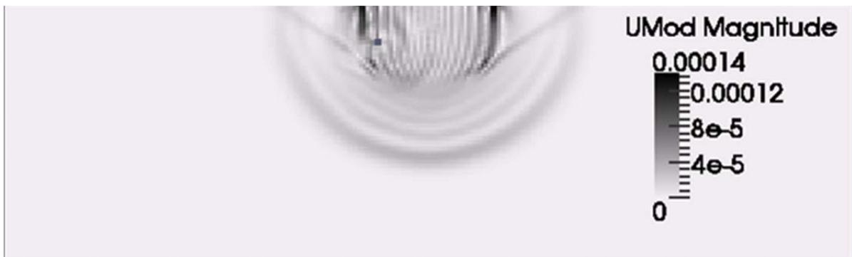
Figura 7-5. Magnitud de los desplazamientos alrededor de un orificio de forma cuadrada con condición de contorno de superficie libre ( $t=0.165$  seg.)
